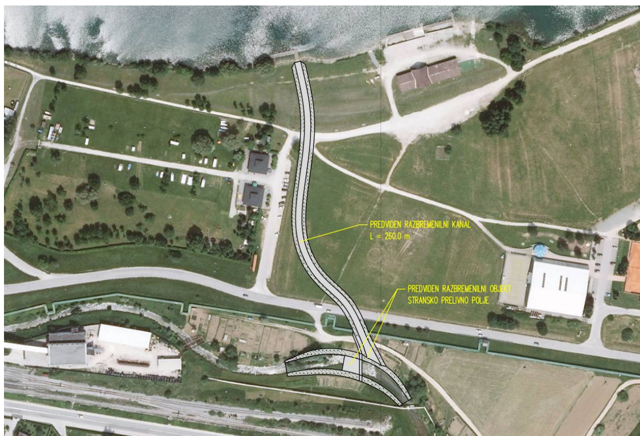
Slika 56: Predvidena lokacija umestitve razbremenilnega kanala, pogled gorvodno. (foto: D. Lajevce, sep 2013)
